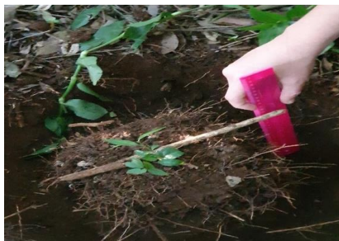
Imagem 4: Marcação do monólito de terra, contendo 25cm x 25cm e profundidade aproximada de 20cm
