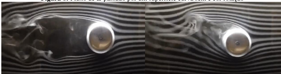
Figura 6: Fluxo de ar passado por um superfície curva sem e com rotação
