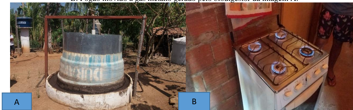
Figura 1. A. Biodigestor de matéria orgânica oriunda de bovinos e que tem como produto o gás metano (CH 4 ). B. Fogão movido a gás metano gerado pelo biodigestor da imagem A.
