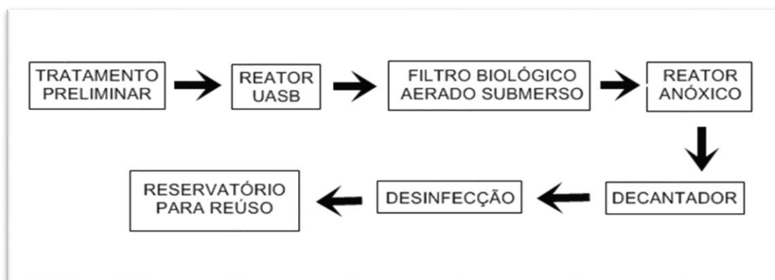
Figura 1 – Etapas do Tratamento Biológico da Estação de Tratamento da Indústria
