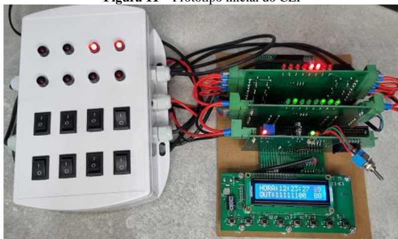
Figura 11 – Protótipo inicial do CLP
