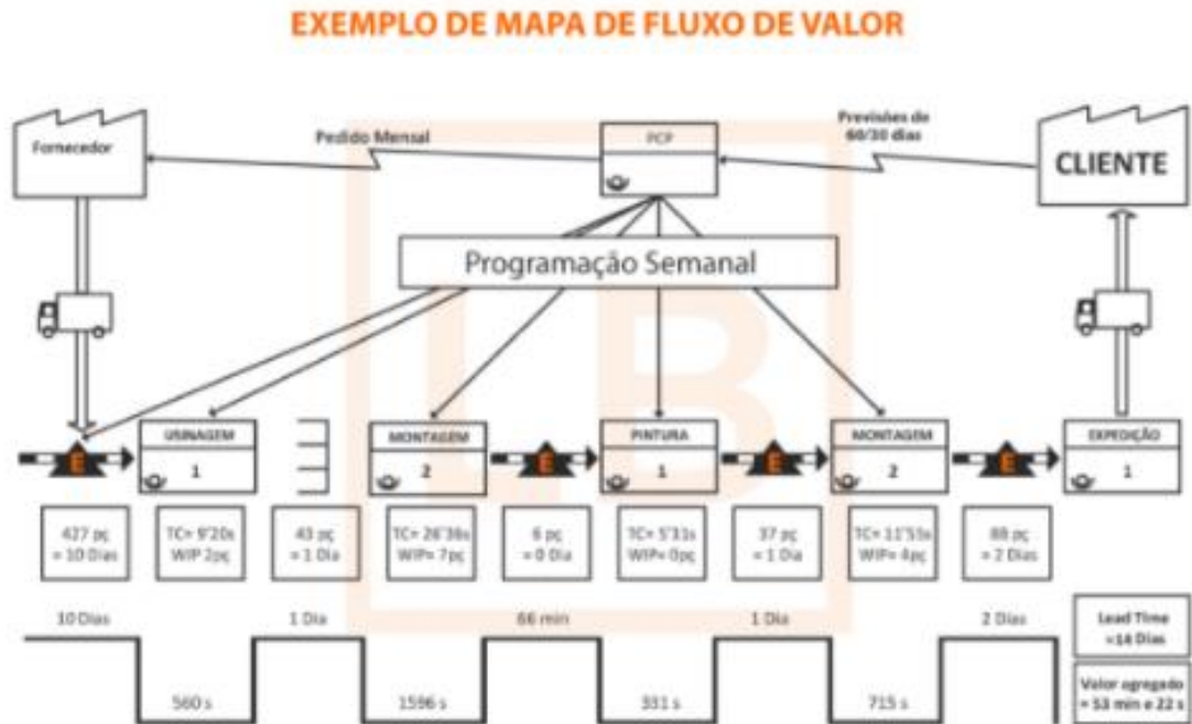
Figura 2: Exemplo de mapeamento de fluxo de valor.
