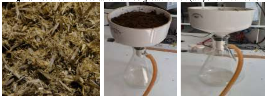
Figura 1.8: substrato resultante da biodigestão e extração por bomba vácuo
