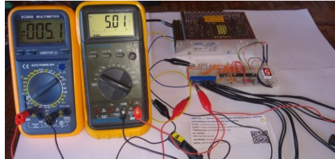
Figura 10: Coleta de tensões e correntes, sinais dos níveis 5 a 0
