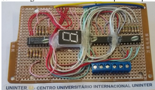
Figura 6: Montagem circuito eletrônico na placa de prototipagem
