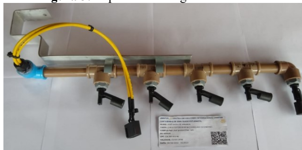
Figura 3: Suporte e montagem dos sensores
