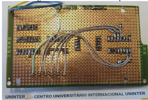
Figura 5: Montagem circuito eletrônico na placa PCI fundo
